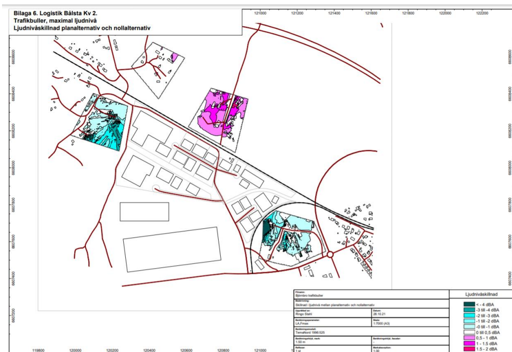
Illustration av den skillnad i ljudnivåer som planförslaget innebär. Byggnader skärmar av och skyddar i vissa fall från befintligt trafikbuller samtidigt som det genererar ökad trafik och därmed ökat buller i andra fall.
